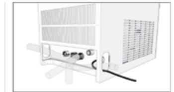
Conexión de entrada y vaciado de agua
